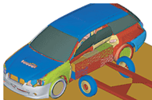
車両の側面衝突の解析結果
