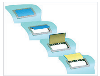
エアバッグリッドの展開シミュレーション
